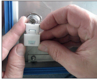
Insérer et positionner le dispositif de verrouillage
