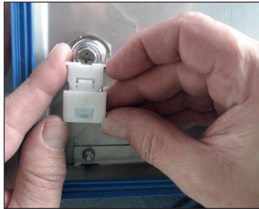
Verriegelungskeil einschieben und einrasten
